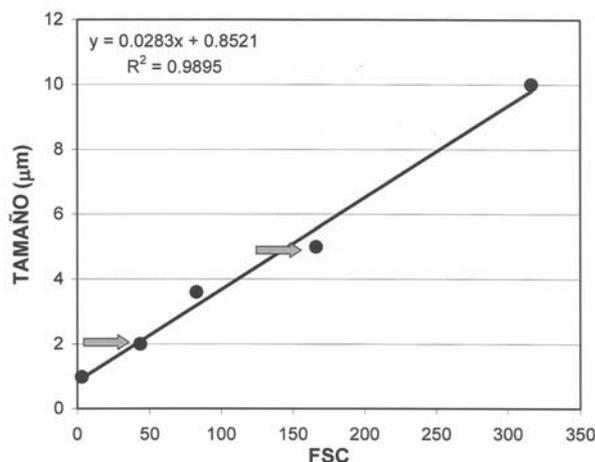
**Figura 3.** Relación entre los valores medios de los canales de dispersión frontal de luz (FSC) y de los tamaños de las partículas (DEE) para el conjunto de bolas de calibración y para las muestras fraccionadas procedentes de la laguna Honda (puntos señalados por flechas). *Relationship between the frontal light scattering channel and the size of the particles (DEE) corresponding to the calibration beads and the fractionated samples from Honda lake (dots pointed by arrows).*
